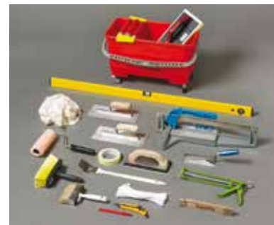
Verktøy som bør brukes til membran, flis- og fugearbeider på badet.
