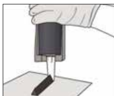
Figur 3 Påfør SikaTack® Panel lim med et triangulært munnstykke.
